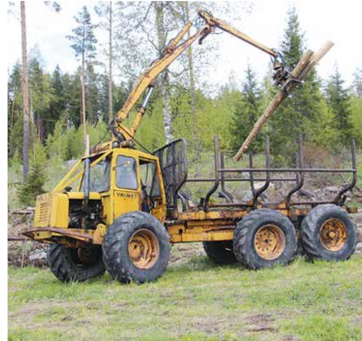
↑ Valmet Terra 865 oli 60-luvun lopulla eniten myyty kuormaakantava metsätraktori, ja ulkonäkönsä puolesta oikein pätevän oloinen kone. Maavaraa oli mukavasti, kuormatila teleineen vankasti tehty ja turbiniäkin 80 hv:n Terrasta löytyi. Valmet 565:n voimansiirto-osat ja etenkin vähennyspyörästöt ratkeilivat sikäli tiuhaan, että tehdas joutui tekemään kaikkiin myytyihin koneisiin lukuisia vahvistuksia. Nolon maineen saanut Terra-kausi jäi parin vuoden mittaiseksi, seuraava CK-malli oli kokonaan toisenlainen.
