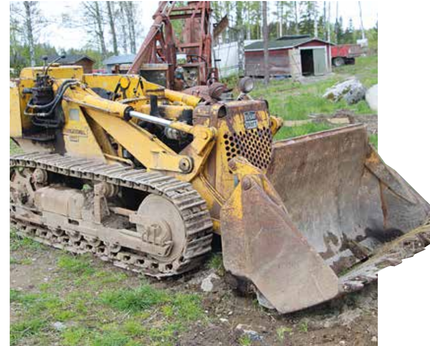
↑ Pohjasta aukeava Drott-kauha oli yleisimmin International-tela-kuormaajissa, mutta muissakin merkeissä sitä käytettiin. Paitsi että kauhan tyhjennys oli nopeampaa kuin kippaamalla, sillä pystyi poimaan kiviä tai muuta materiaalia kahmarin tapaan. Kun pohjan nosti ylös, saattoi kauhaa käyttää puskulevynä. Kuvan traktori on 6,7-tonninen International LTD6.
