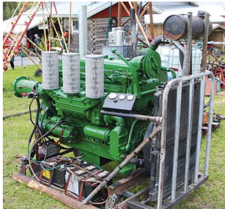
↑ Paukepäivien hurjimmat äänet saatiin aikaiseksi GMC 6-71:llä. Paremmiin Detroit Dieselinä tunnettu 7-litrainen ja 6-sylinterinen moottori kehitettiin toisen maailmansodan kynnyksellä, siitä oli olemassa myös 1-, 2-, 3-, 4-, 8-, 12-, 16- ja 24-sylinteriset versiot. Tästä 6-pyttyisestä on saatu suuttimia vaihtamalla 200-300 hv, yleisin tehollukema oli 240 hv. Detroit Dieselit käytettiin generaattoreissa, maansiirtokoneissa, kuorma- ja linja-autoissa, panssarivaunuissa, vetureissa ja monissa muissa kohteissa, missä piti pieneen tilaan mahduttaa paljon tehoa.
